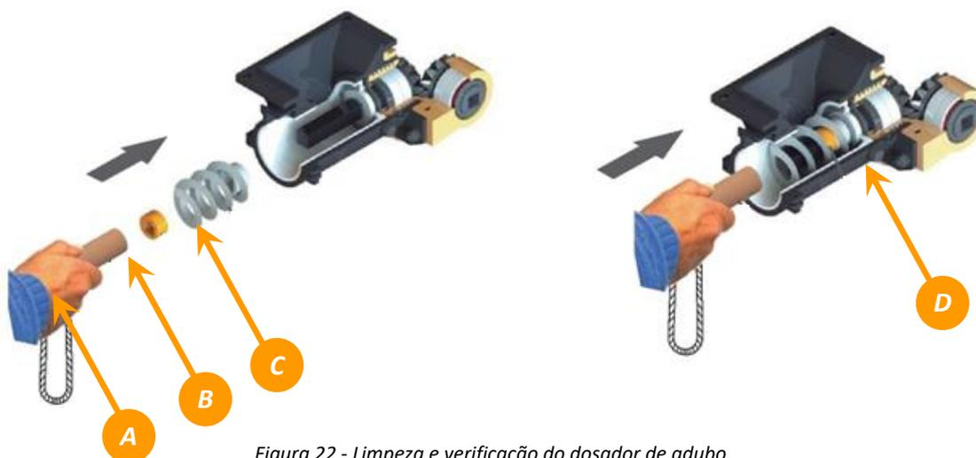
Figura 22 - Limpeza e verificação do dosador de adubo
