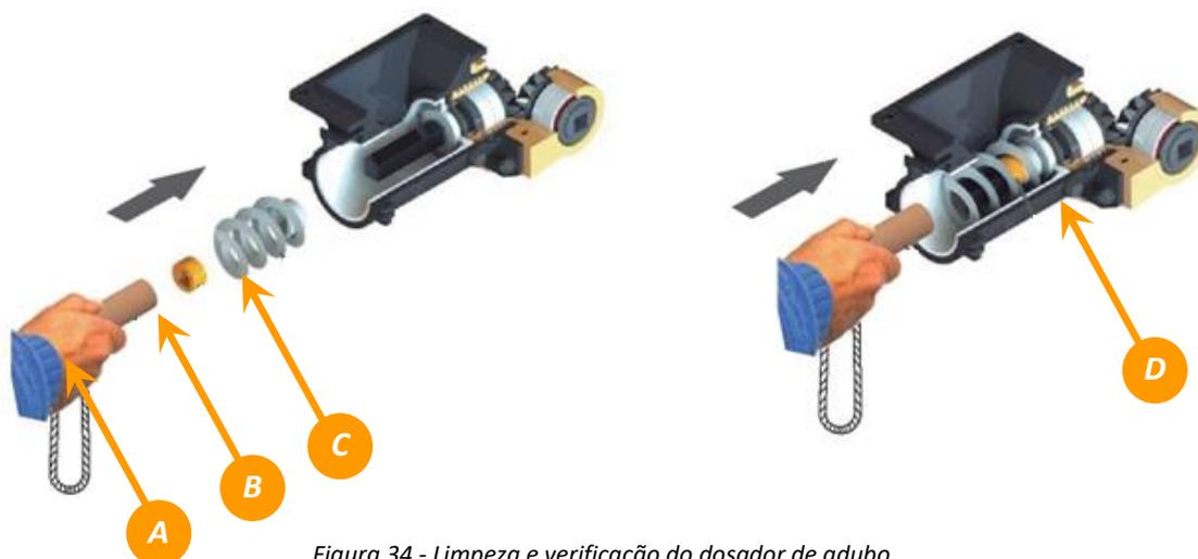
Figura 34 - Limpeza e verificação do dosador de adubo
