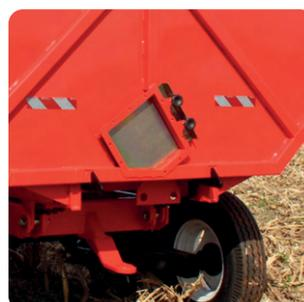
Tampa traseira com saída central para acoplamento de tubo descarregador.
