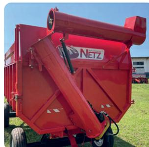
Tubo descarregador de grãos acionado por motor hidráulico.
