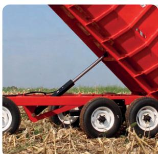
Acionamento através de cilindro hidráulico.
